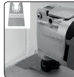
Obr.2, odstraňovanie zvyškov lepidla či tmelu škrabkou
