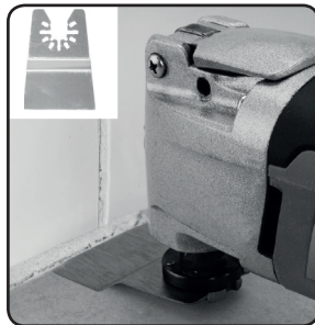
2. ábra. Ragasztó- és tömítőanyag maradványok eltávolítása kaparóval.
